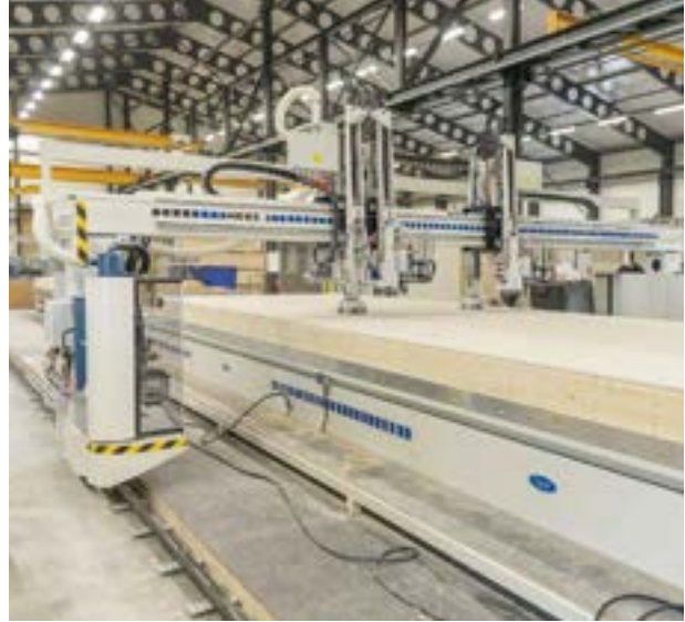
Productielijn (houtskeletbouw) zoals die door Solarge zal worden gebruikt voor de productie van geïntegreerde lichtgewicht zonne-panelen/dakelementen.
